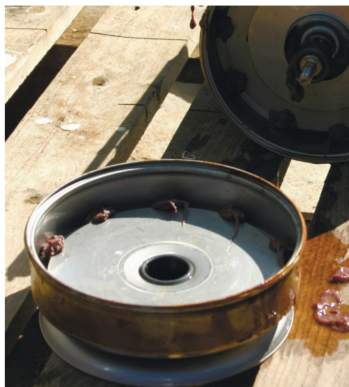
Рис. 1. Обрастание рабочего колеса насоса-сатуратора
