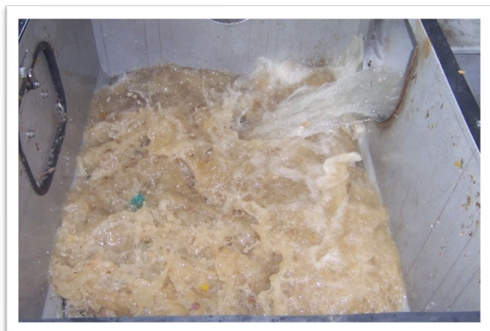
Турбулентная промывка в моечном бункере
